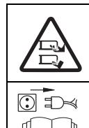
Træk netstikket ud inden arbejdet med skæreværktøjerne påbegyndes! Hold fingre og fodder borte fra skæreredskaberne! Slukfor maskinen og træk stikket ud, inden maskinen indstilles eller rengøres, eller inden det kontrolleres, om tilslutningskablet er snoet eller beskadiget. Hold tilslutningskablet væk fra værktøjerne.
