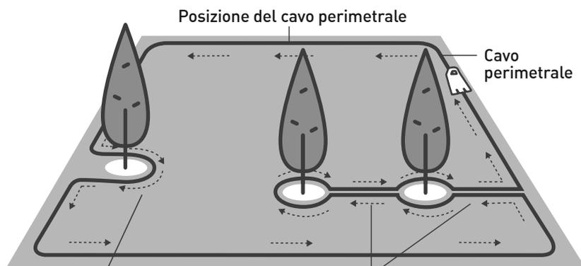
Se la distanza tra un'isola e il cavo perimetrale è inferiore a 1 m, integrate l'ostacolo con il bordo del prato.
