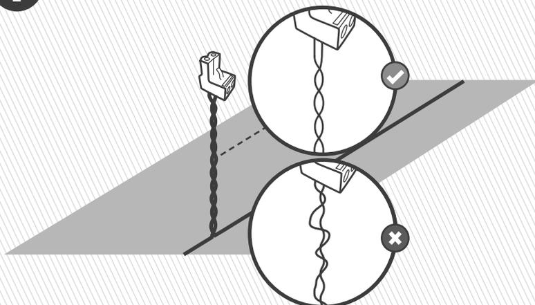
Rimuovete 5 mm di isolante dalle estremità dei fili, inserite il filo attorcigliato nel connettore e fissatelo con un piccolo cacciavite a testa piatta.
