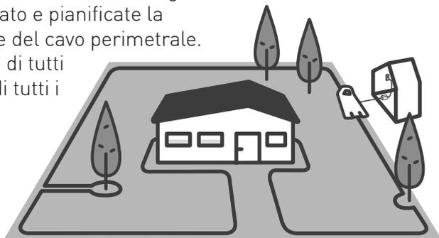
Estraete circa 30 cm di filo attraverso il foro nella copertura di plastica della bobina e fissate a terra l'inizio del filo, nella posizione in cui intendete installare la stazione base.
