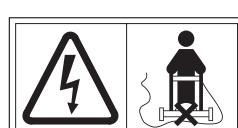
**Varování! „Připojovací kabel chráňte před kontaktem s žacím nožem“**
